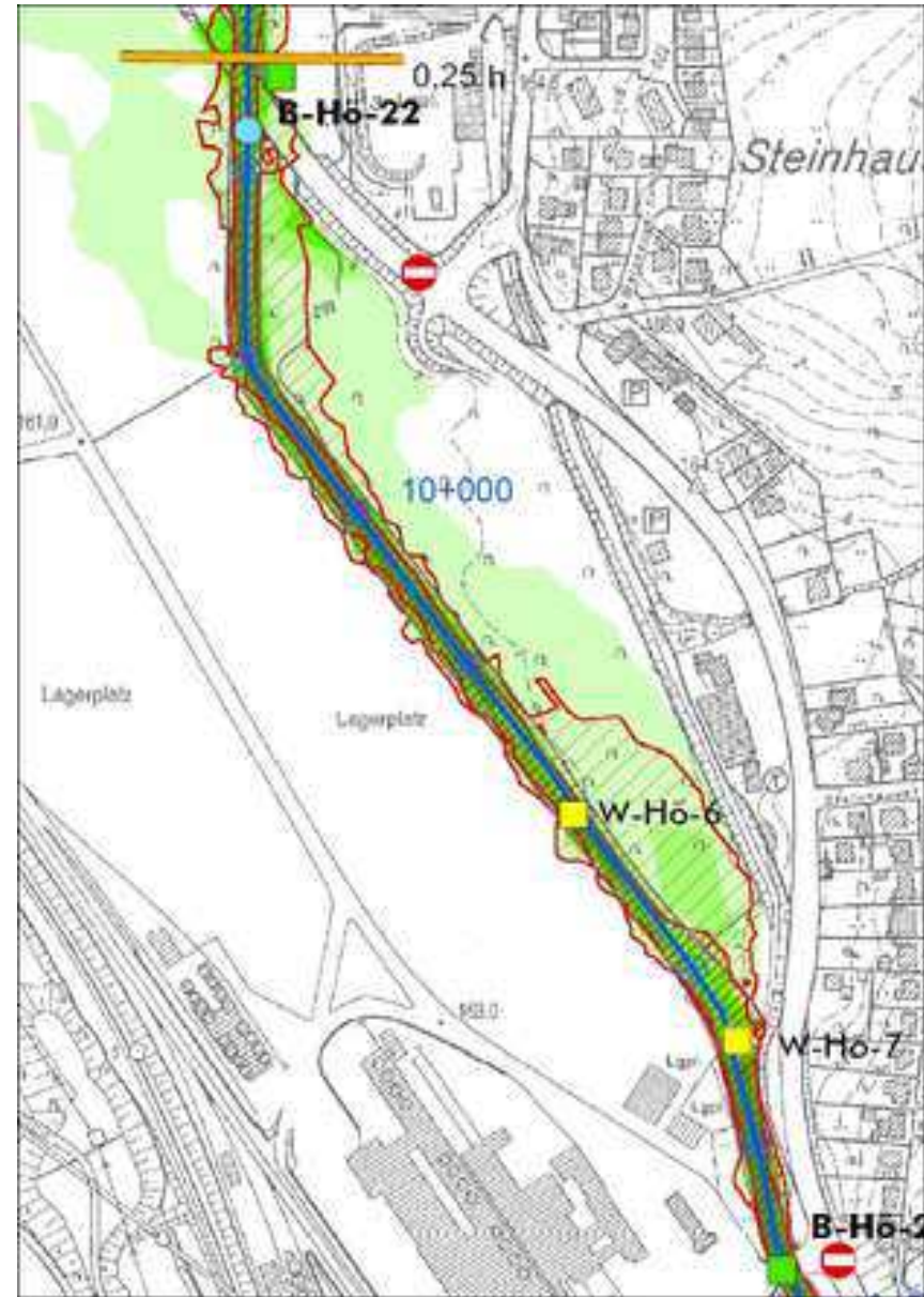
Abb. 6: HQ 25 im Bereich „Sonnenschein“
